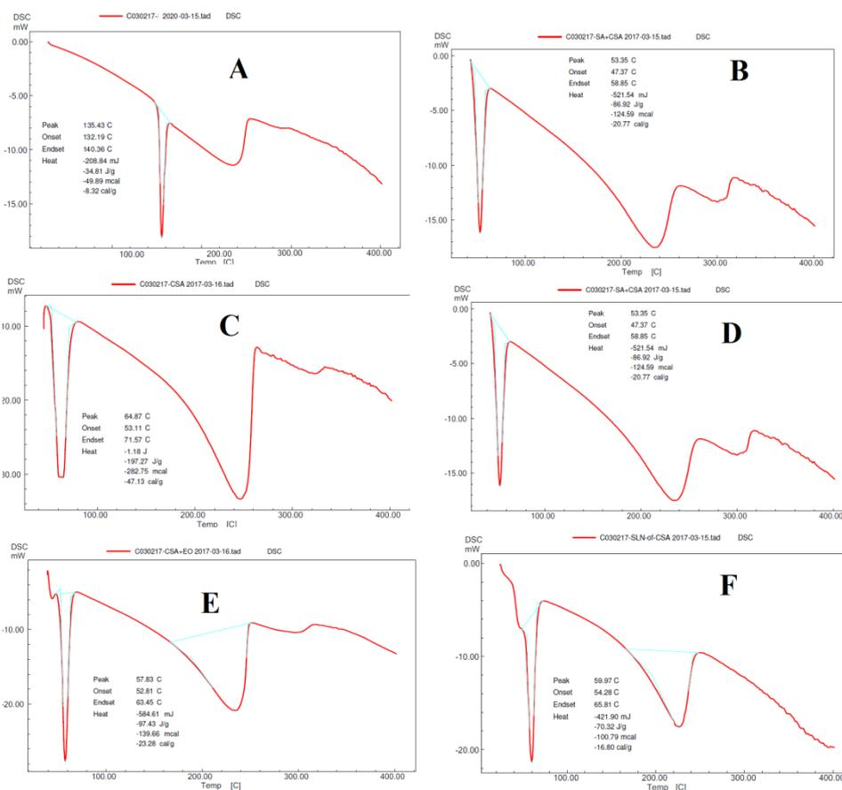
Fig. 4: DSC Thermograms A) Repaglinide B) Cetyl alcohol and oleic acid blend (70:30) C) Cetyl Alcohol D) NLC Formulation E) Blend of cetyl alcohol oleic acid tween 80 F) SLN formulation
