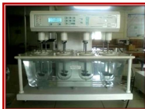
Fig. 2: Dissolution apparatus (USP TDT-08L)
